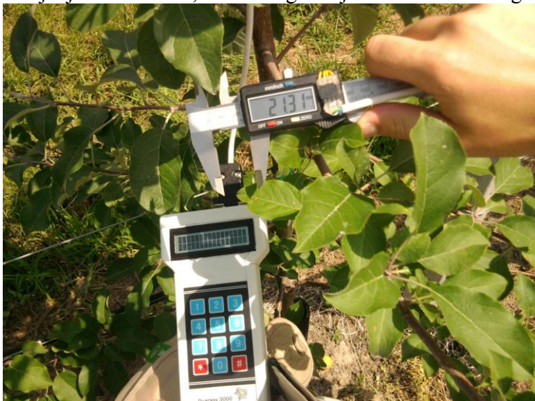
Naprava za merjenje širine debla jablane.
