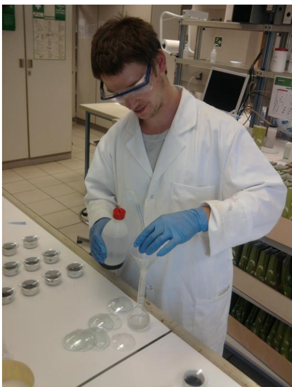
Izpiranje prsti brez organskih snovi z šibko klorovodikovo kislino.
